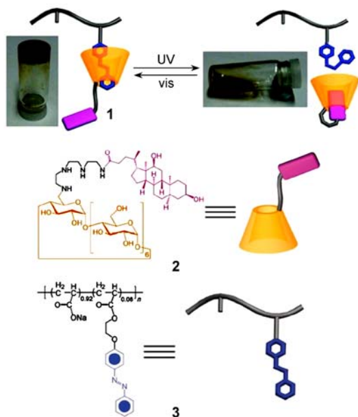
图5 超分子复合凝胶1在355nm紫外光照射下形成 \beta -环糊精衍生物2和含偶氮苯结构的共聚物3的溶胶; \beta -环糊精衍生物2和含偶氮苯结构的共聚物3的溶胶在450nm可见光照射下形成一个超分子的凝胶复合结构1 [9]
