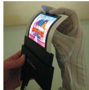
图 6 不锈钢基板柔性 AMOLED 器件弯曲示意图 [56]
