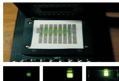
图 7 以复印纸为基底的柔性显示器件 [61]
