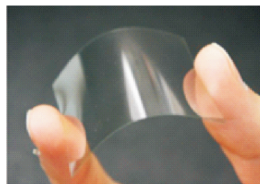
图 2 聚合物基板示意图 [6]
